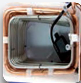
Sistema refrigeración banco de hielo.
