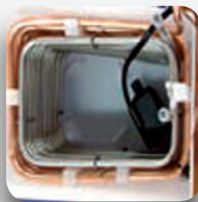
Sistema refrigeración banco de hielo.
