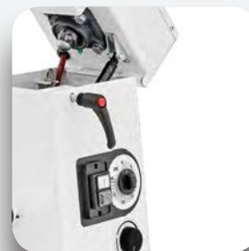
Variador de velocidad.
